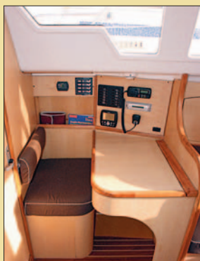
On s'installe confortablement au coin navigation face à la marche. Le plateau mesure 72 x 51 cm. À la gîte, bâbord amures, on cherche un appui pour se caler. On aimerait aussi quelques rangements supplémentaires.
