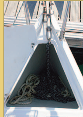
La baille à mouillage est profonde mais mal conçue: pour la fermer, l'ancre doit être avancée de 10 cm sur son davier. De plus, la chaîne ne peut sortir par l'avant: il reste donc toujours de la chaîne sur le pont.
