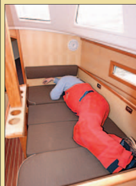
Le carré dînète permet à quatre convives de s'attabler. Une rallonge porte la table à 80 x 136 cm pour atteindre la banquette bâbord. Pour la nuit, il est possible d'aménager une couchette double en quelques secondes.
