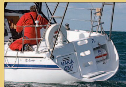
Intégrée au tableau arrière, cette échelle en polyester qui équipait déjà le Bi-loup 89 est une vraie trouvaille: l'accès au bateau est possible même à l'échouage.
