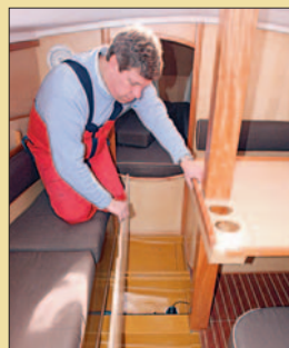
Les fonds sont renforcés par un contremoulage qui présente sept varangues et un bâti pour le moteur. La coque est très robuste: 14 à 16 mm sous la flottaison, 8 à 10 mm ailleurs. Des échantillonnages très supérieurs à la moyenne.
