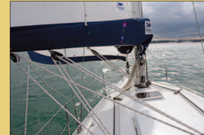
La grand-voile se borde grâce à un double palan fixé sur le rouf. Cette installation a le mérite de soulager les efforts subis par la bôme et se révèle pratique à l'usage.
